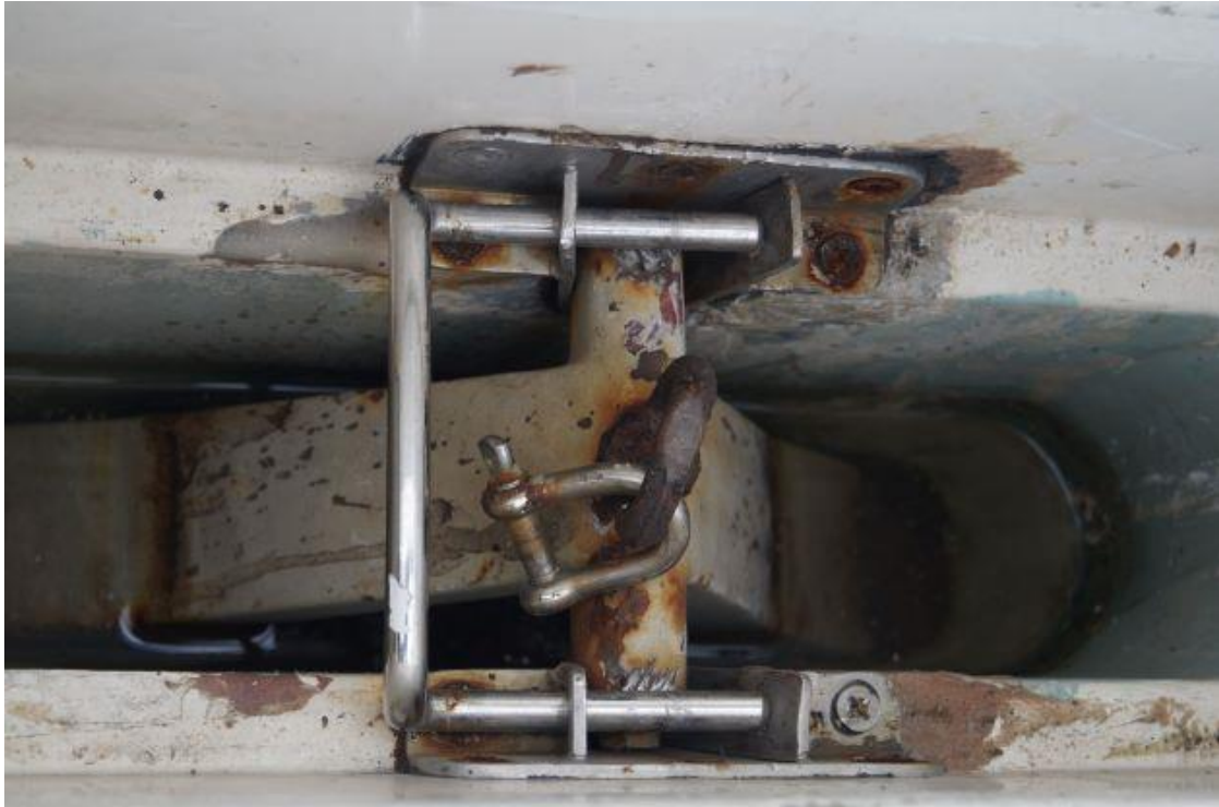
Zdjęcie 9 – otwory w gnieździe blokowania miecza nie są w jednej osi i nie pozwalają na właściwe zabezpieczenie płetwy balastowej.
