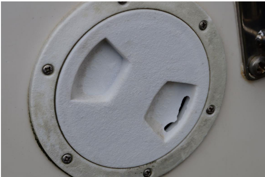
Zdjęcie 8 - uszkodzona zakrętka luku kontrolnego
